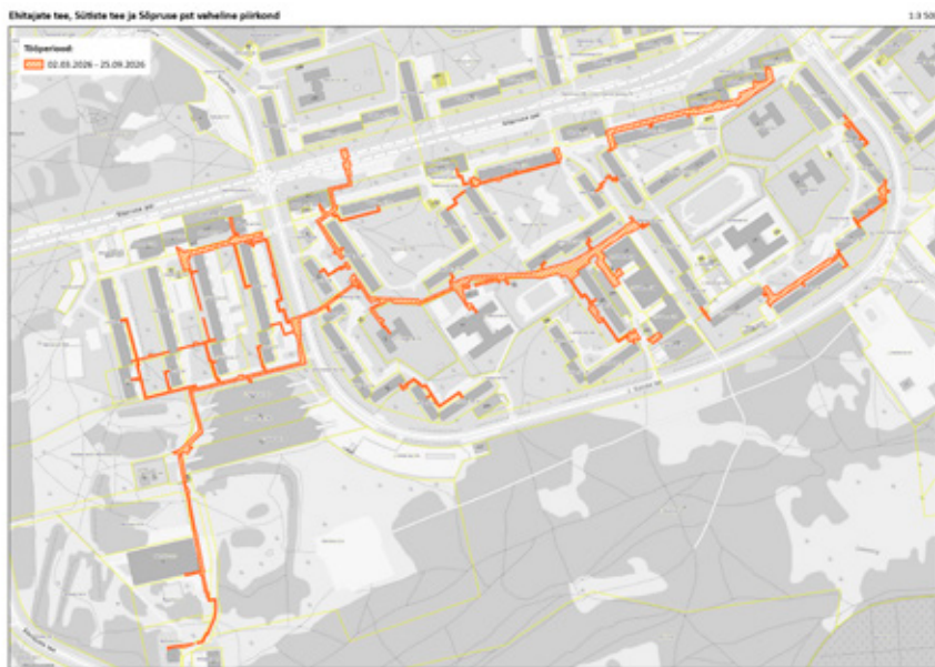
Skeemid „Rekonstrueeritav soojustorustik Ehitajate tee, Sütiste tee ja Sõpruse pst ning Mustamäe tee, Tammsaare tee, Vilde tee ja Sõpruse pst vahelises piirkonnas“.
